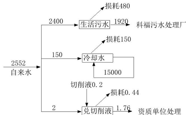
图 2-1 水平衡图 (t/a)
