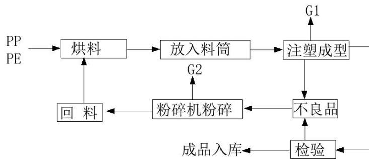
图 2-2 注塑产品生产工艺流程图
