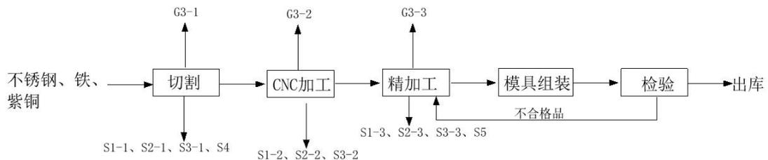
图 2-3 注塑模具工艺流程及产污环节图
